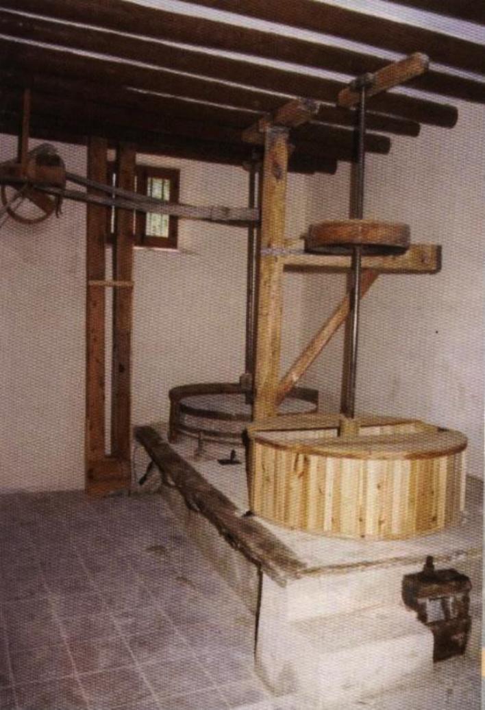
En la planta baja se ubica la maquinaria precisa para la Molinería, esto es: la fabricación de la harina por molienda del trigo. La operación comprende varias fases –limpia, molienda, cernido y sasado de sémolas– y el trabajo se reparte entre las dos plantas.
